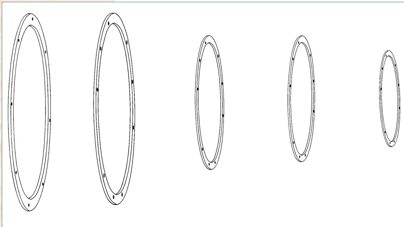
**L**es cercles au perçage « SOMAC » se soudent sous le talon des jantes et permettent de recevoir les fixations « UNIVERSEL » et les barillets extérieurs au même perçage.
