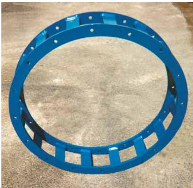
Ces élargisseurs ou rétrécisseurs se montent entre la jante et le voile et permettent d'augmenter ou de diminuer la voie selon le montage choisi.
