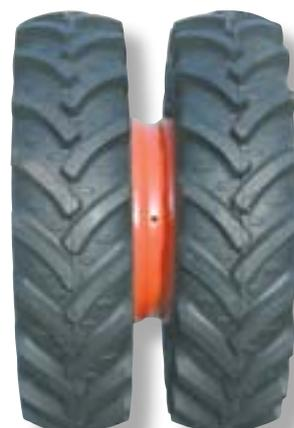
Les 2 ou 3 écrous à calotte se montent sur la jante d'origine.
