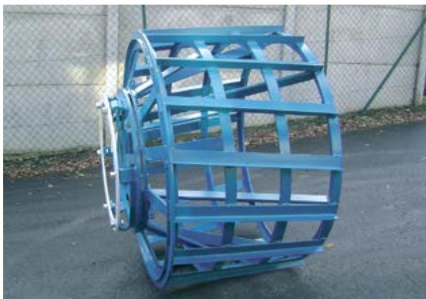
Cette roue s'adapte sur la fixation "universel" et elle est munie d'un cercle de roulement, pour réaliser de courts déplacements sur les chemins empierrés, sans obtenir de secousses importantes.
