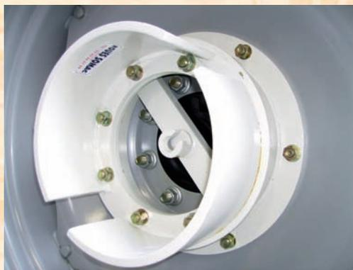
Le porte masse est boulonné sur le voile d'origine du tracteur.
